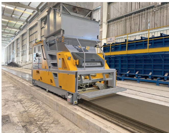
Качество поверхности плит, изготовленных с использованием экструдера EVO2 от Nordimpianti
