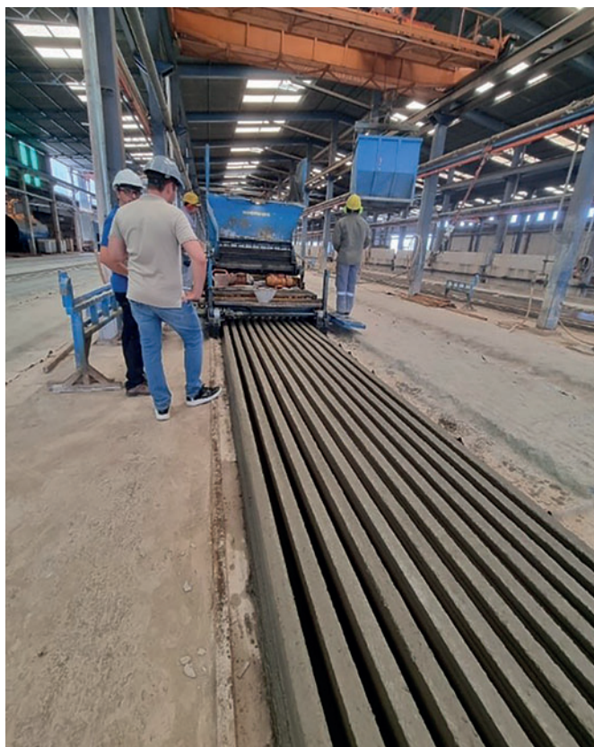
Заливка двутавровых балок толщиной 210 мм с использованием слипформера фирмы Nordimpianti
