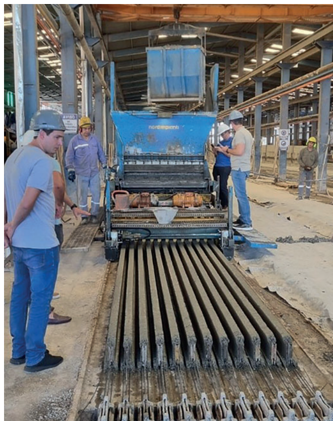
Заливка двутавровых балок толщиной 210 мм с использованием слипформера фирмы Nordimpianti
