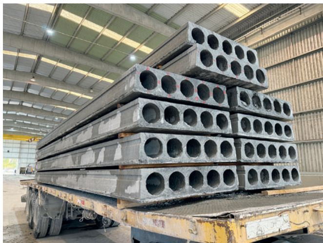
5-пустотные плиты, отформованные с использованием экструдера EVO2 от Nordimpianti
