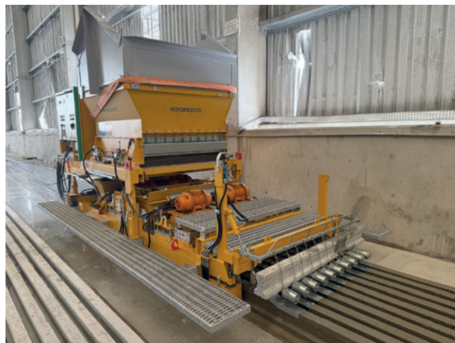
Слипформер Nordimpianti для изготовления двутавровых балок
