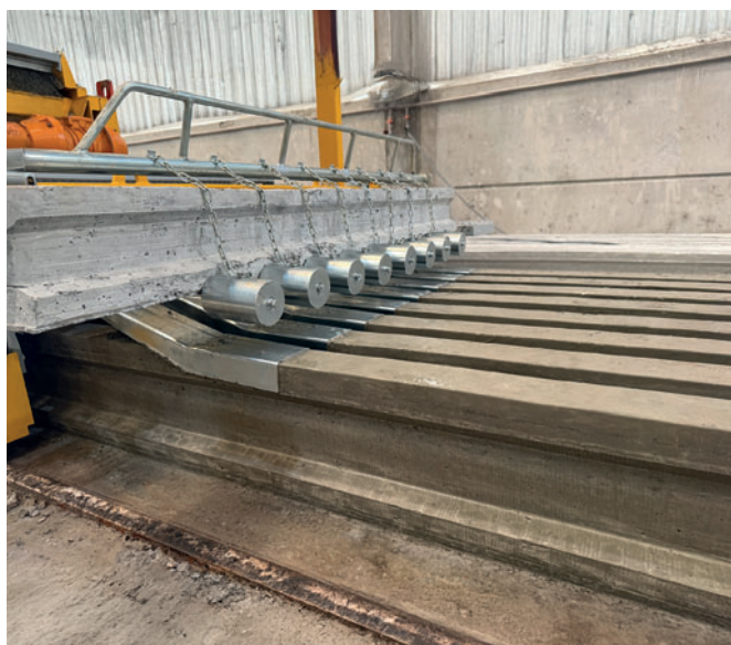
Двутавровые балки, изготовленные с использованием слипформера от Nordimpianti
