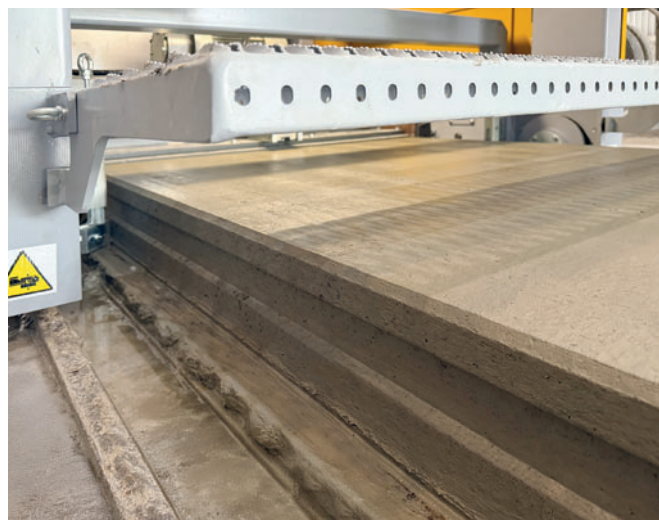
Качество поверхности плит, изготовленных с использованием экструдера EVO2 от Nordimpianti
